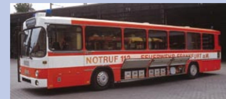
Großraum-RTW der BF Frankfurt. In den Stauräumen des Busses befinden sich Großunfallsets, mit denen 300 Personen versorgt werden können. Die Boxen sind farblich gekennzeichnet. Weitere Großunfallsets sind auf den Feuerwachen hinterlegt.
