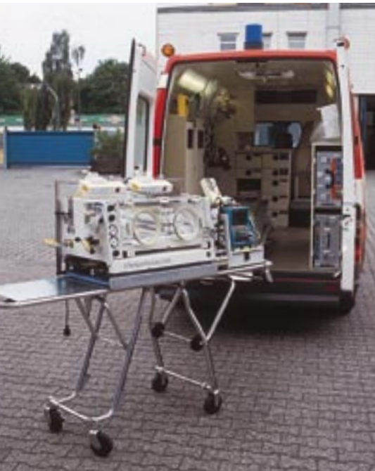
Frankfurter Baby-NAW: Der Inkubator wird ständig bei einer Temperatur zwischen 35 und 36 Grad gehalten.
