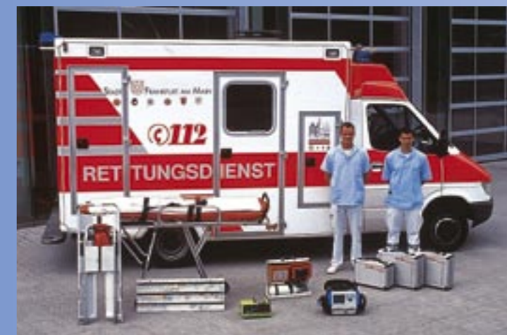
Der Frankfurter „RTW 2000“, in diesem Fall von der Feuerwehr. Ausgestattet sind die Fahrzeuge unter anderem mit Ferno-Trage mit integrierter Vakuummatratze, Spritzenpumpe, Oxylog 1000, Defibrillator Zoll, Notfallkoffer Kinder/Baby, Herz/Kreislauf und Beatmung. Auf dem Foto Rettungsassistent Markus Wilhelm (links) und Rettungssanitäter Ralf Bittner.
